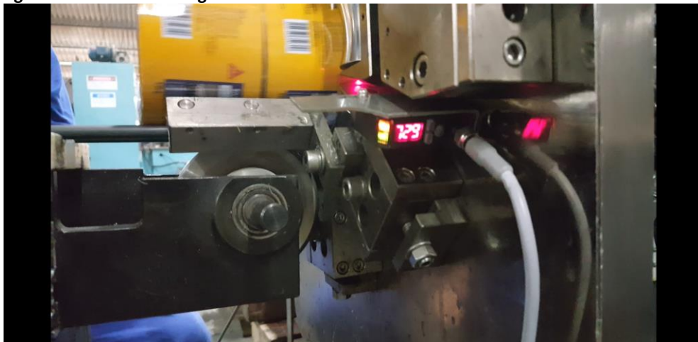
Figura 2 – Coroa de soldagem com sensor a laser
